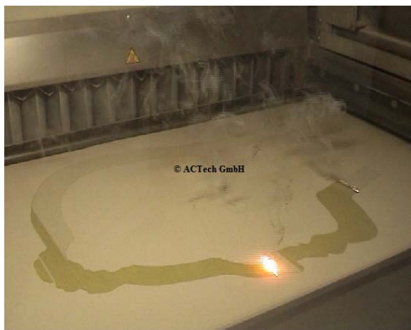
Abbildung 7: Laser-Sintern eines Formteils
