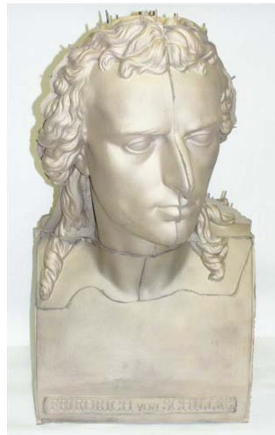
Abbildung 13: Das Rohgussteil (Gusskörpergewicht 240kg)
