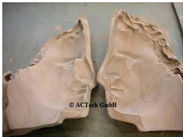
Abbildung 8: Im Laser-Sintern hergestelltes Formteil
