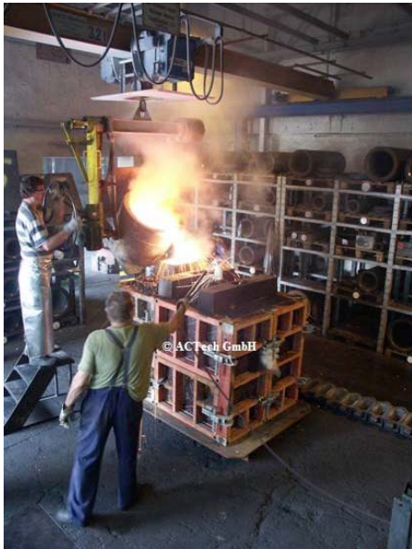
Abbildung 11: Abguss in G-CuSn5ZnPb im Sächsischem Metallwerk Freiberg/Sa.
